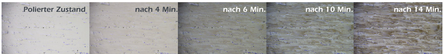
Ätzmittel: CLTH004 AluPro Etch - Elektrolyt-Ätzlösung, 22 V - Werkstoff: Aluminium 7000er Knetlegierung - Vergrößerung: 50 : 1
